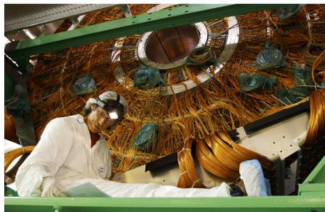
**Abbildung 1.1:** Elektromagnetischer Kalorimeter des ATLAS-Detektors[2].
