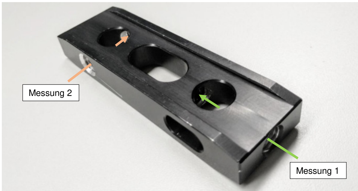
Abbildung 12: Bohrungsmessstellen an der Wasserwaage
